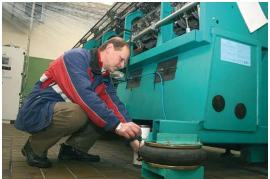
Profesor Lubomír Pešík kontroluje vibroizolační uložení, které je tvořeno kombinací pneumatických a pryžových pružin
